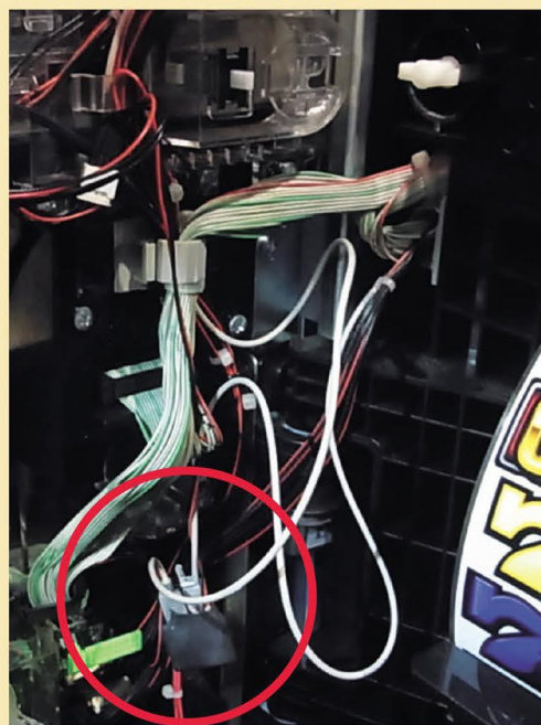
回胴式遊技機の主基板とサブ制御基板を繋ぐハーネスに取り付けられた電子部品のぶら下がり
