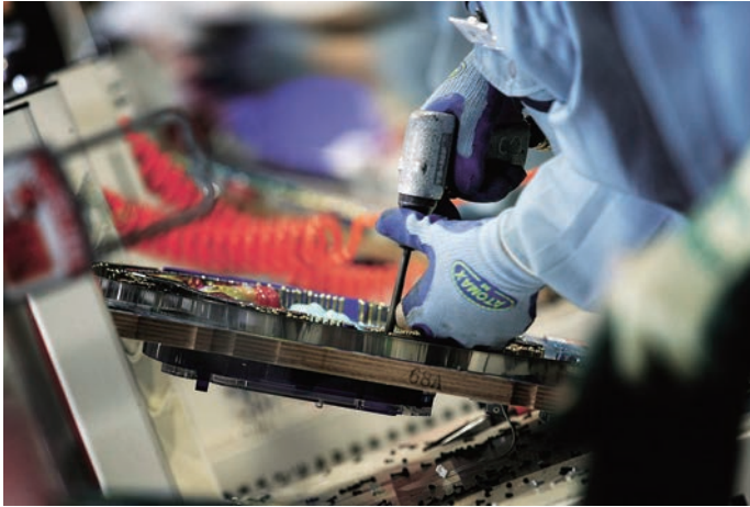
解体・分別は基本的に手作業。注意点がリサイクル推進委のガイドラインで細かく規定されている
